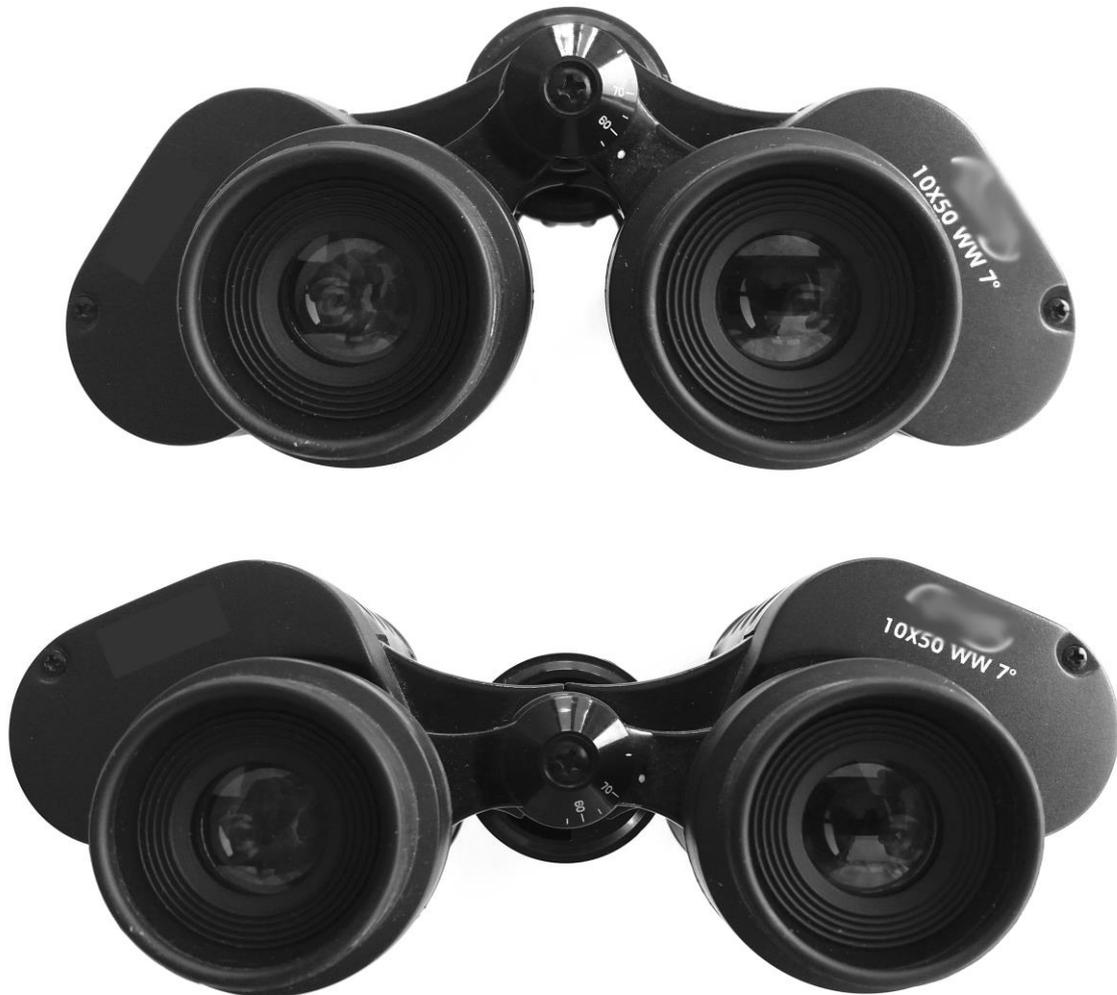
**Binocolo con oculari alla minima distanza (sopra) e alla massima distanza (sotto)**
